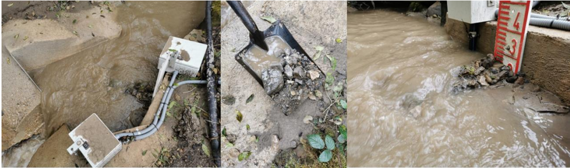
Figura 32: Fotografías de algunos momentos en los que la estación de aforos se ha colmatado de sedimentos enterrando las sondas y el tubo de entrada del tomamuestras.
