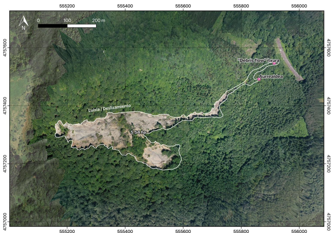
Figura 22: Con el ortomosaico derivado de las imágenes fotogramétricas obtenidas por el dron en junio 2020 y el trabajo de campo se genera la superficie actualizada del deslizamiento.
