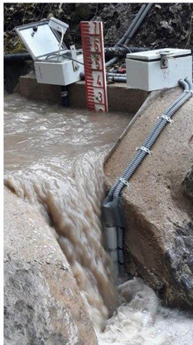
Figura 33: Nueva ubicación de la sonda de turbidez y del tubo del tomamuestras tras el 23 de octubre de 2020.
