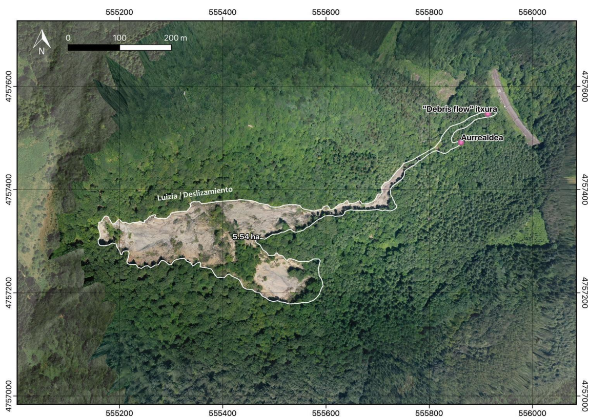
Figura 8: Con el ortomosaico derivado de las imágenes fotogramétricas obtenidas por el dron en junio 2020 y el trabajo de campo se genera la superficie actualizada del deslizamiento.
