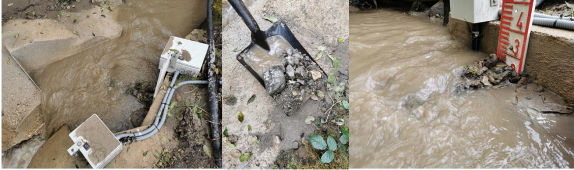
Figura 6: Fotografías de algunos momentos en los que la estación de aforos se ha colmatado de sedimentos enterrando las sondas y el tubo de entrada del tomamuestras.
