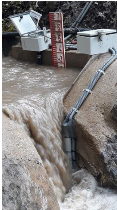
Figura 7: Nueva ubicación de la sonda de turbidez y del tubo del tomamuestras tras el 23 de octubre de 2020.
