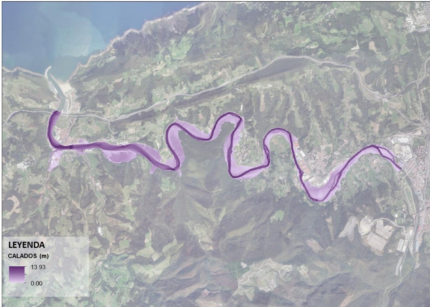
Figura 50 Mapa calados Tramo Zubieta-Orio (Cuenca río Oria). Escenario de cambio climático RCP 4.5, periodo de retorno de 50 años.
