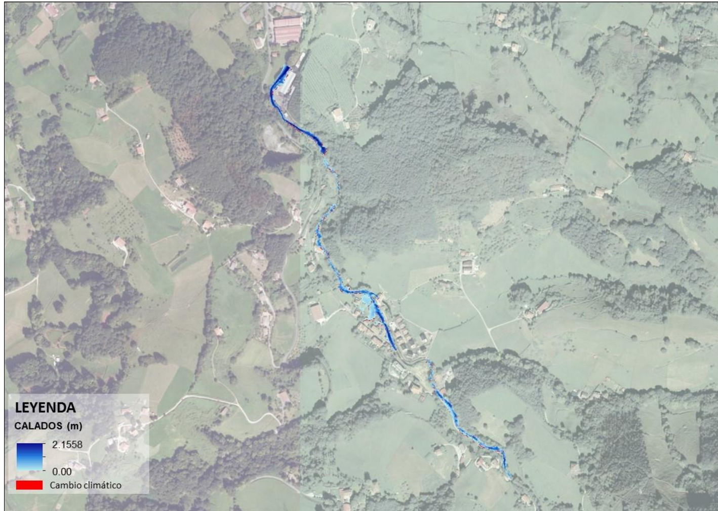
Figura 79 Mapa comparativo calados Tramo Karrika (Cuenca río Oiartzun). Clima actual-Escenario de cambio climático RCP 8.5, periodo de retorno de 25 años.
