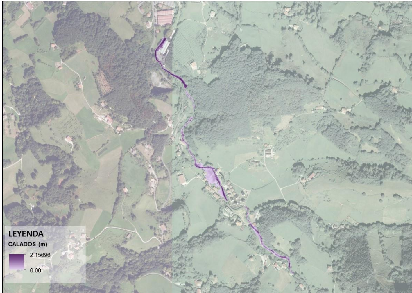
Figura 77 Mapa calados Tramo Karrika (Cuenca río Oiartzun). Escenario de cambio climático RCP 8.5, periodo de retorno de 50 años.
