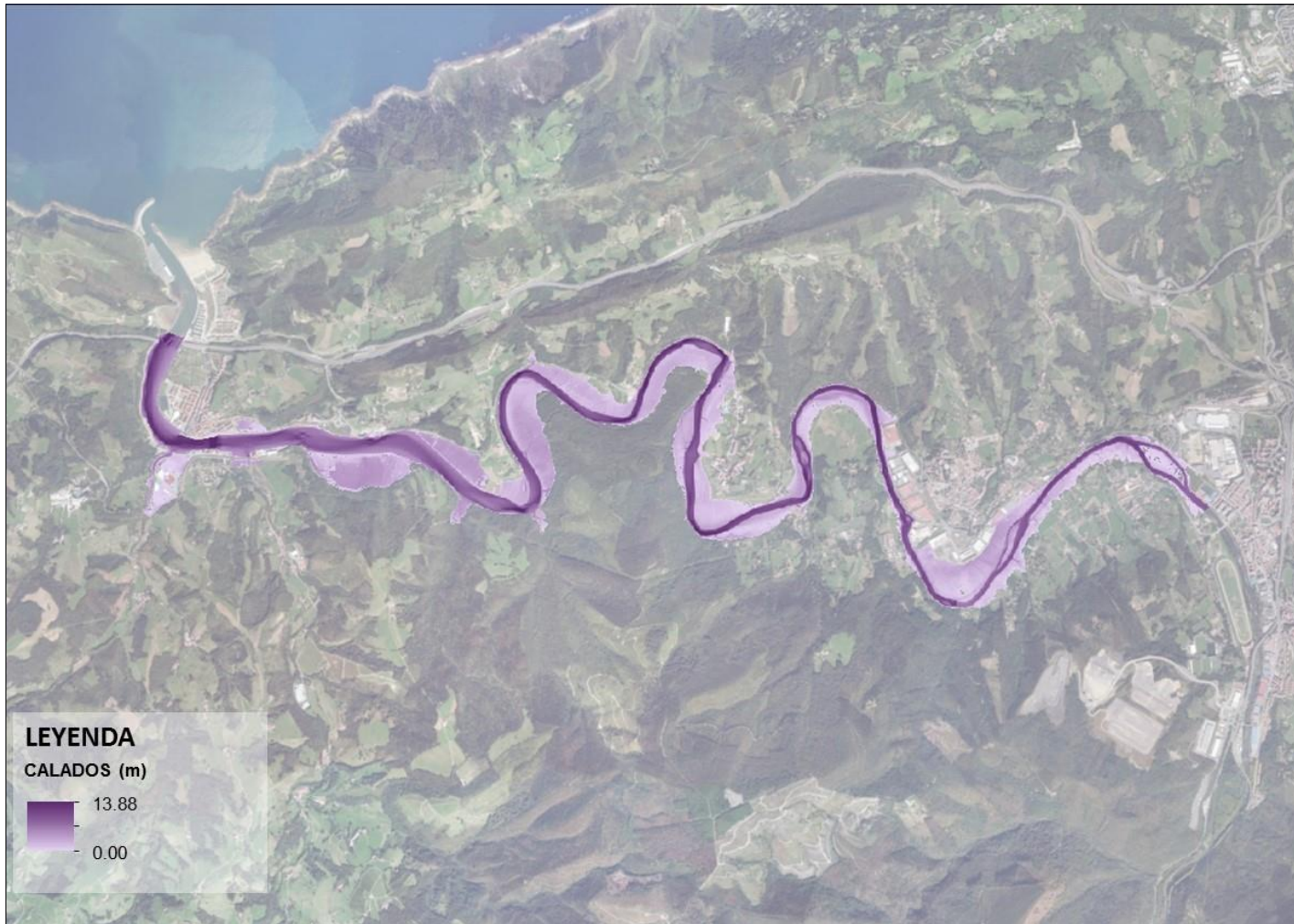
Figura 48 Mapa calados Tramo Zubieta-Orio (Cuenca río Oria). Escenario de cambio climático RCP 4.5, periodo de retorno de 25 años.
