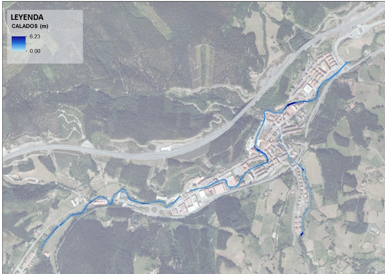
Figura 36 Mapa calados Tramo Escoriatza (Cuenca río Deba). Escenario de clima actual, periodo de retorno de 10 años.
