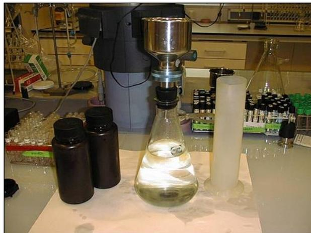
**Figura 7.** Filtración para el análisis de clorofila.
