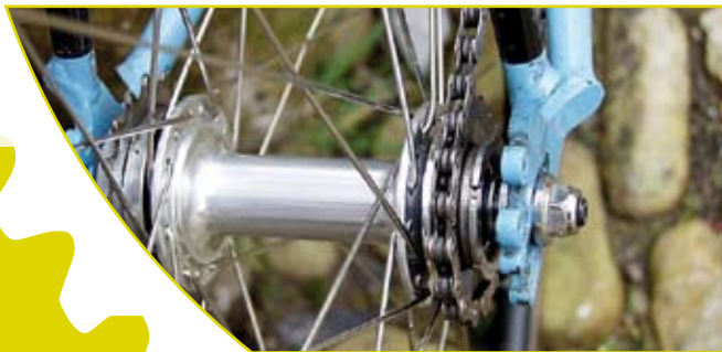
Fixed-gear bizikleta baten pinoia eta katea / Detalle de piñón y cadena de una fixed-gear. Argazkia / Foto: Andy Armstrong (Creative Commons Attribution-Share Alike 2.5 Generic)
