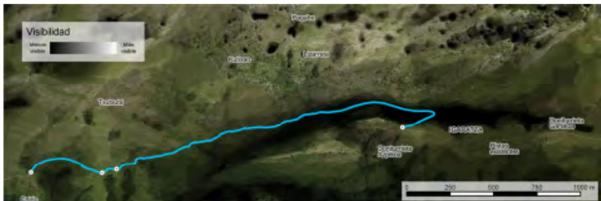
Figura 18 Representación de la visibilidad en el entorno del trazado propuesto. Cuanto más claro es un ámbito, más visible resulta desde los 12 puntos de observación planteados. También se muestran los 4 puntos más visibles del trazado, que se emplean en la valoración de la intervisibilidad.
