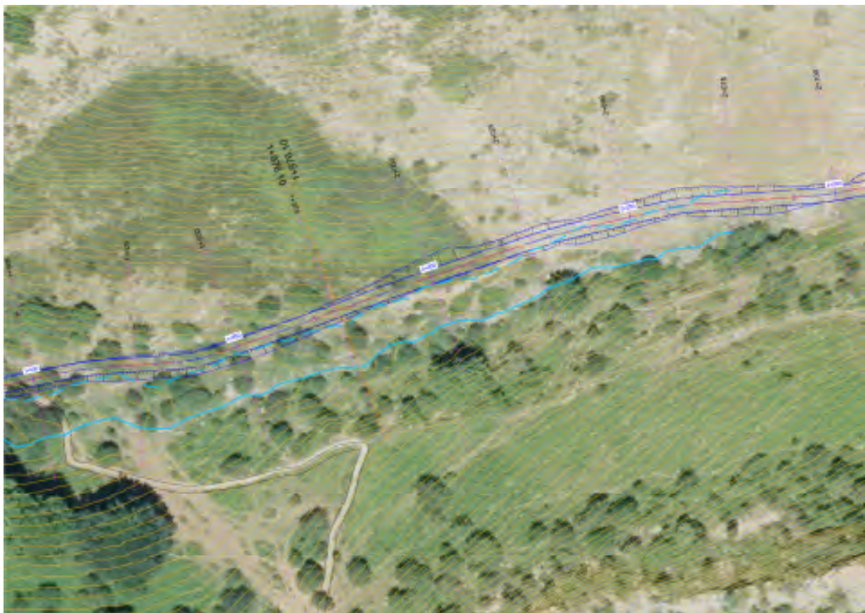
Figura 14 En la figura se muestra el único tramo del trazado que se aproxima al cauce. El resto del recorrido mantiene un retiro muy superior al recomendado por la regulación. Se representa en azul oscuro el trazado propuesto para los accesos, y en azul claro el cauce (línea continua) y el retiro (línea discontinua).
