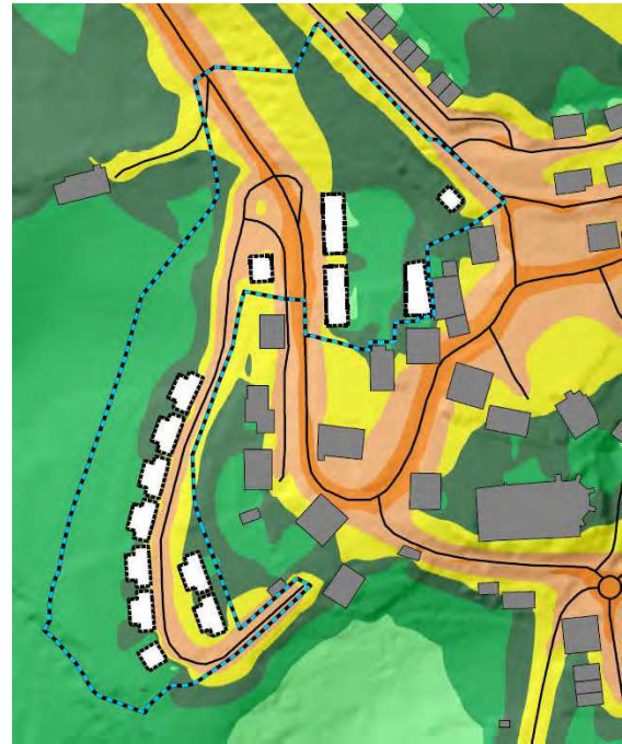
Figura 16. Superficie afectada por la isófono de 60 dB (A) (línea roja, uso del suelo residencial) a 2 metros sobre el terreno, correspondientes al periodo día (Ld), en situación futura con reducción de velocidad a 50 km/h.
