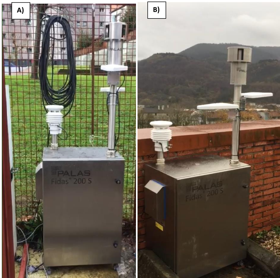
5. Irudia. PM_{10} , PM_{2.5} eta PM_{10} partikulak kuantifikatzeko PALAS kaptadoreak, kontrol eremuan (Urretxu) [A] eta eraginpeko-eremuan (Usurbil) [B].
