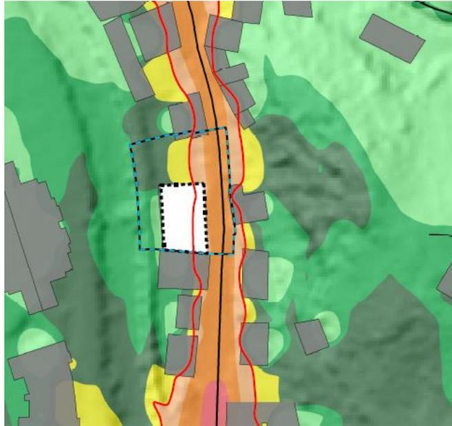
Figura 11: Superficie afectada por la isófona de 50 dB (A) (línea roja) a 2 metros sobre el terreno correspondiente al periodo noche (Ln).
