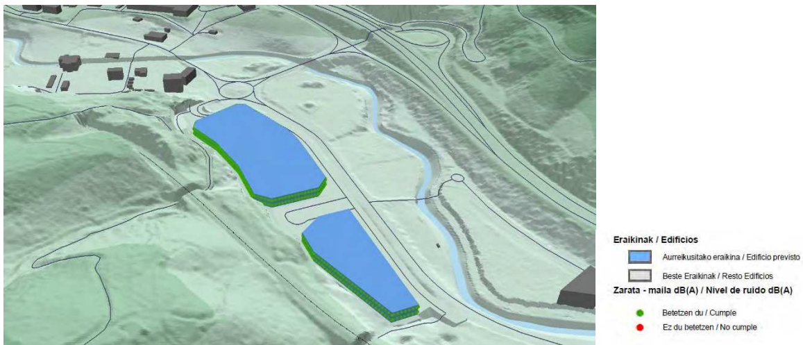
Figura 12. Vista 2 con niveles de ruido en fachadas para el periodo día (Ld), tarde (Le) y noche (Ln).
