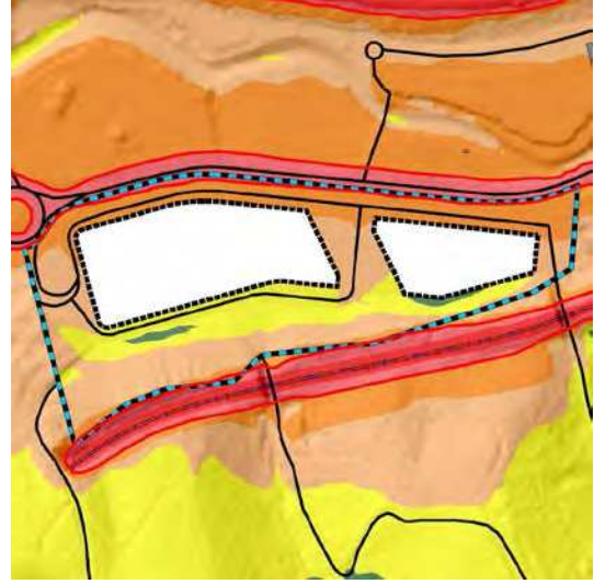
Figura 4. Superficie afectada por la isófona de 60 dB (A) (línea roja, uso del suelo industrial) a 2 metros sobre el terreno, correspondientes al periodo noche (Ln), alternativa descartada.
