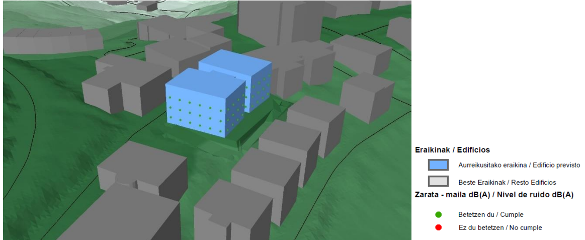
Figura 12. Vista 2 con niveles de ruido en fachadas para los periodos, día, tarde y noche (Ld, Le, Ln).
