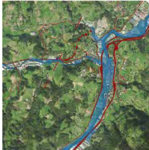
10.12 Fig. Zona inundable para periodo de retorno de 500 años ARPSI Villabona. Elaboración propia a partir de los datos de URA y UDALPLAN.
