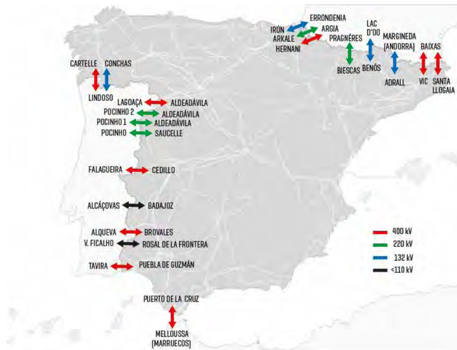
13.7 Fig. Mapa de interconexiones del sistema eléctrico con Francia, Portugal y Marruecos. Fuente: Red Eléctrica de España.
