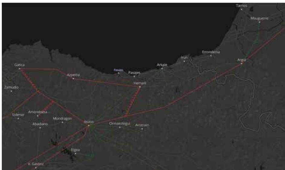
13.6 Fig. Red de sistemas de transmisión de la red de energía eléctrica. Se incluyen todas las líneas de transmisión para 220kV (verde) y 400 kV (rojo) y las subestaciones eléctricas de reparto. Fuente: Mapa de sistema de transmisión ENTRSO-E 52 .
