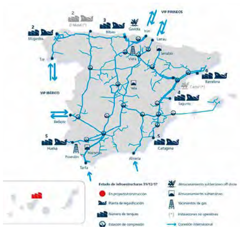
13.5 Fig. Mapa de las infraestructuras gasistas en España. Fuente: SIDE GAS Informe 2017.
